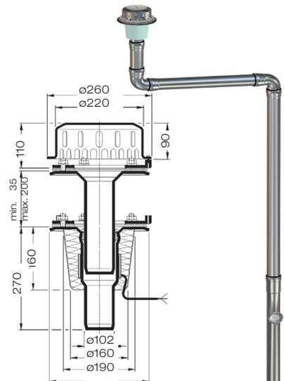
**Begleitheizung:** Wir empfehlen, nach Prüfung Dachabläufe und Leitungen in frostgefährdeten Bereichen gegebenenfalls mit einer bauseitigen Begleitheizung zu versehen.
