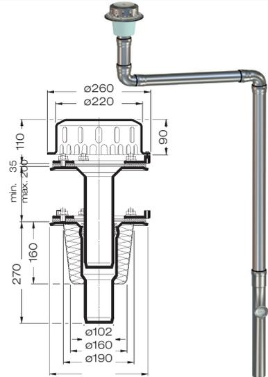
mit Wärmedämmung und Heizung
